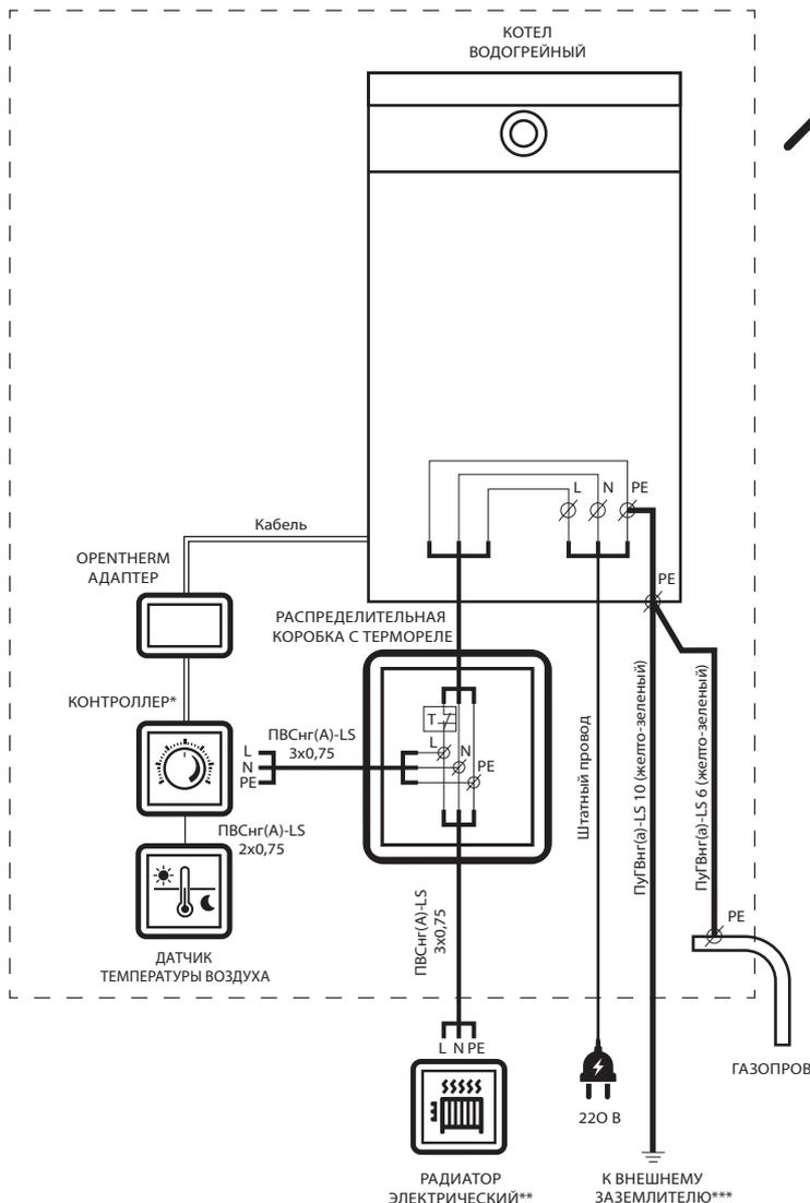
ЭЛЕКТРИЧЕСКАЯ СХЕМА КНР-МОГ С КОМНАТНЫМ ТЕРМОСТАТОМ
