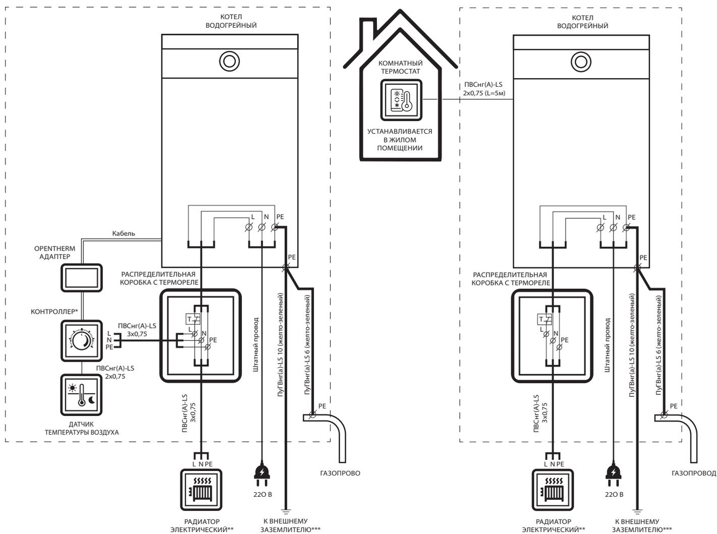
11. СХЕМА ПОДКЛЮЧЕНИЯ АВТОМАТИКИ ZONT (ОПЦИЯ)
